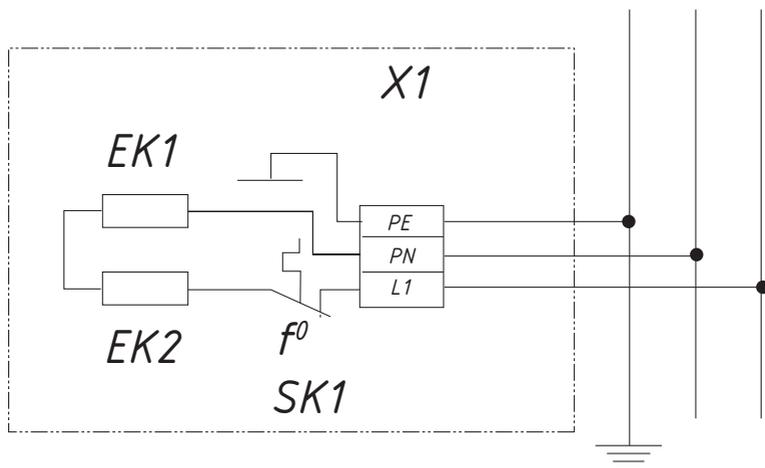
Рис. 5. Схема подключения обогревателей IO-05, IO-10, IO-15, IO-20, IO-30
