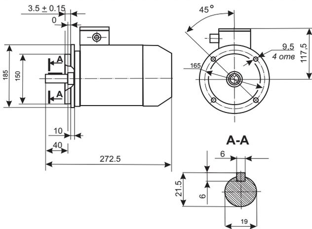
Двигатели изготавливаются по ТУ РБ 05755950-458-94. Двигатели АИР71Ш предназначены для привода промышленных швейных машин при работе от сети частоты 50 Гц.
